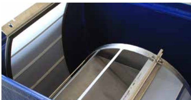
Panele filtracyjne łatwo jest zdemontować.
