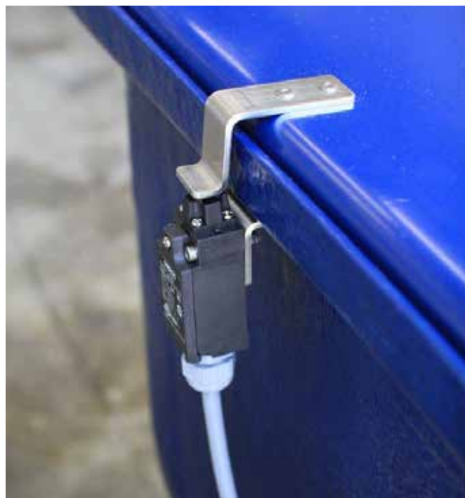
Wyłącznik zabezpieczający – zatrzymuje bęben przy otwartej pokrywie.
