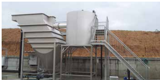
Lamella LS to Separator Lamella ze stożkowym zbiornikiem zagęszczania osadu.
